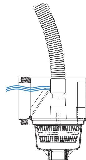
**Vakuumscheibe** zum Anschluss von Bodensaugern, 32 / 38 / 50 mm
