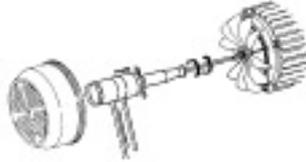
Prüfen, ob die Drehrichtung des Motors mit der Angabe auf dem Typenschild übereinstimmt (der Lüfter des Motors muß sich von hinten gesehen im UHRZEIGERSINN drehen). Bei einer Pumpe mit Dreiphasenmotor müssen bei falscher Drehrichtung zwei Phasen der Netzleitung am Schutzgerät vertauscht werden.
