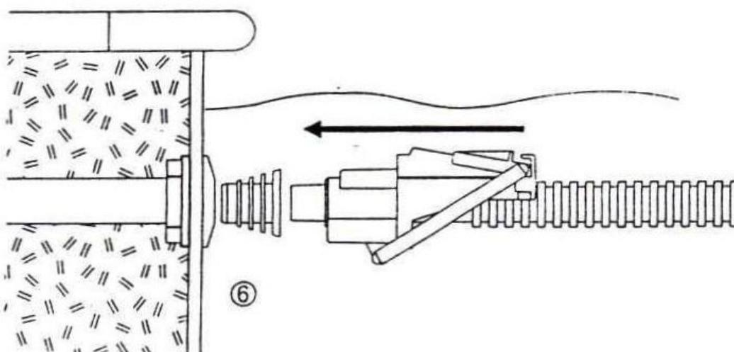
**UPOZORNĚNÍ:** SUPER G+ můžete připojit na přípojku sání pro čistící zařízení bazénů rovněž bez automatického regulačního ventilu průtočného množství. V tomto případě musíte pomocí dodávaného měřicího přístroje sání zkontolovat, zda sací výkon postačuje pro uspokojivý čistící výkon Vašeho SUPER G+.
