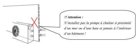
■ Le réchauffeur devrait être placé sur une construction solide, droite et non corrosive, capable de supporter le poids de la pompe à chaleur. Elle doit être fixé à l'aide des vis aux fondations en béton.
