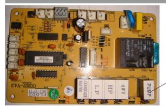
Phase de sortie L<sub>1</sub> pour la commande de la bobine du contacteur de la pompe de filtration
