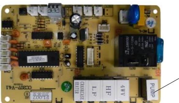
Ausgangsphase L<sub>1</sub> zur Bedienung der Schützspule der Filtrationspumpe
