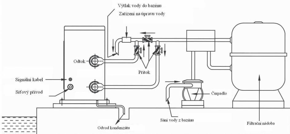
vytlak vody do bazenu = Ausdruck des Wassers ins Schwimmbecken; odtok = Abfluss; prítok = Zufluss; signalni kabel = Signalkabel; odvod kondenzatu = Kondensatableitung; sani vody z bazenu = Wasseransaugung aus dem Schwimmbecken; cerpado = Pumpe; filtracni nadoba = Filtrationsbehälter
