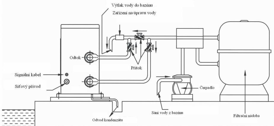
Instalace (připojení) do technologie (potrubí) bazénu musí být provedena pomocí bypassu, opatřeném uzavíracími ventily. Tento bypass (uzavírací ventily) slouží k regulaci průtoku (vstupního tlaku vody) do tepelného čerpadla. Regulace průtoku vody se řídí dle parametrů jednotlivých typů tepelných čerpadel - viz tabulka a technický štítek přístroje. Nedodržení těchto pokynů může vést k poškození tepelného čerpadla.
