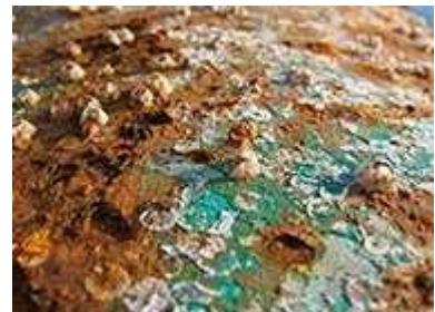
*Korozija klorida:* kada je zaštitni pasivni sloj oštećen na malim odvojenim mjestima na površini nehrđajućeg čelika pojavljuju se rupice, a na površini se nakupljaju kloridi.
