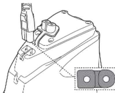
3. Připojte externí adaptér ke zdroji napájení. Jakmile začne nabíjení, kontrolka na externím adaptéru se rozsvítí červeně. Když je robot nabítý, kontrolka na externím adaptéru se rozsvítí zeleně.
