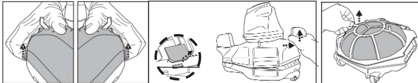
2. Vyndeje kryt filtru a odstraňte nečistoty z prostoru. Doporučuje se čistit síť filtru proudem vody. Pokud je považováno za nutné kartáčování, čistěte jej opatrně a jemně pouze měkkým kartáčem, aby nedošlo k poškození.
