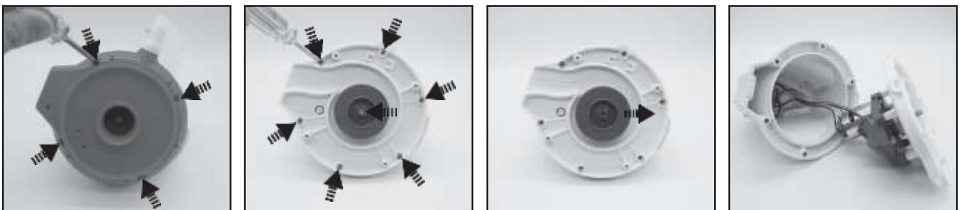
3. Vyjměte baterii, abyste odkryli desku plošných spojů. Chcete-li odpojit připojovací vodič baterie, zatlačte na sponu konektoru a vytáhněte jej. POZNÁMKA: Konektor okamžitě obalte izolační páskou, aby nedošlo ke zkratu způsobenému kontaktem obou svorek vodiče.
