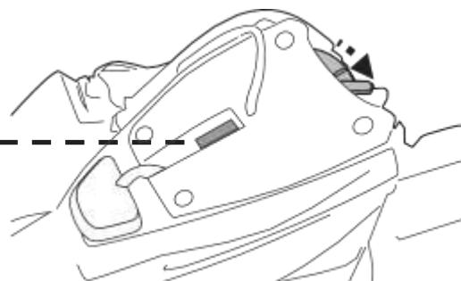
3. Posuňte vypínač do polohy „ON“ (když je robot stále ponořen) - rozsvítí se kontrolka a automaticky se aktivuje motor (hladina vody zakrývající senzory v horní části otočné hlavy). Nechte robota klesnout na dno bazénu a sledujte jeho první pohyby dopředu a dozadu přes dno bazénu. Pokud místo kolmo vede podél stěny bazénu, vytáhněte jej a znova nasadte, přičemž se ujistěte, že jeho přední / zadní strana směruje ke stěně bazénu
