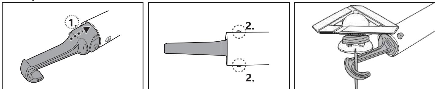
Jakmile robot dosáhne vodní hladiny, najděte úchop, který je pod základnou a je označen symbolem ruky (viz obrázek níže), abyste usnadnili vytažení z bazénu. Ujistěte se, že vždy uchopíte robota za tuto část, aby sezabránilo vypadání nečistot zpět na bazénu.
