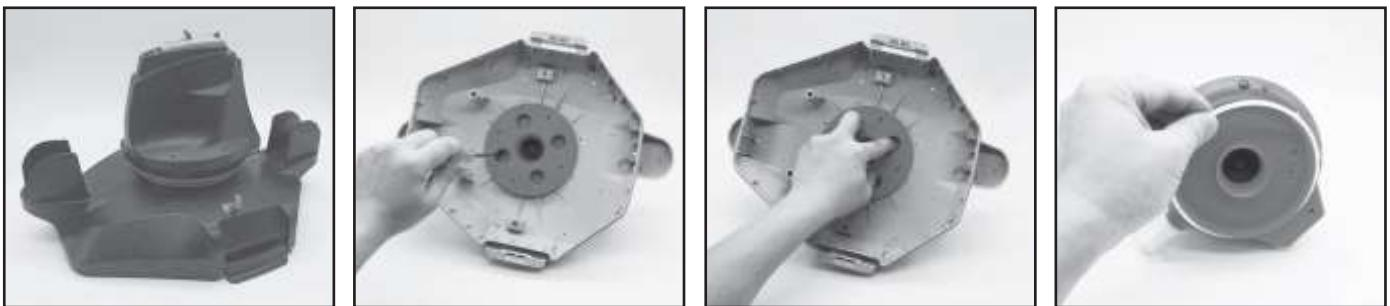
2. Pomocí šroubováku odšroubujte 4 šrouby umístěné ve spodní části hlavy, abyste nejprve uvolnili spodní desku. Poté odšroubujte všechny šrouby na základně, jak je znázorněno. Vyjměte rotor a vypáčením základny odkryjte vnitřek.
