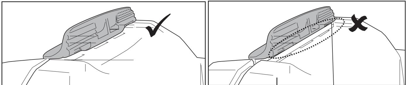
**TIPY:** Před opětovným umístěním vysavače do bazénu přidržte křídla na horním krytu těla, aby se robot mírně pohnul, abyste zajistili, že je horní kryt připevněn k základně.
