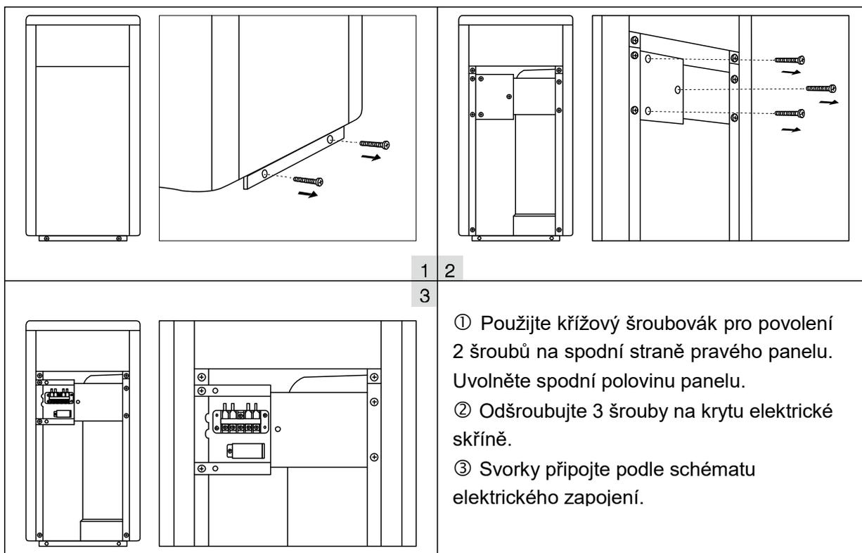
**Poznámka:** u modelu IPHCR15-33 otevřete pro elektrické připojení zadní panel. Postup je stejný jako výše.
