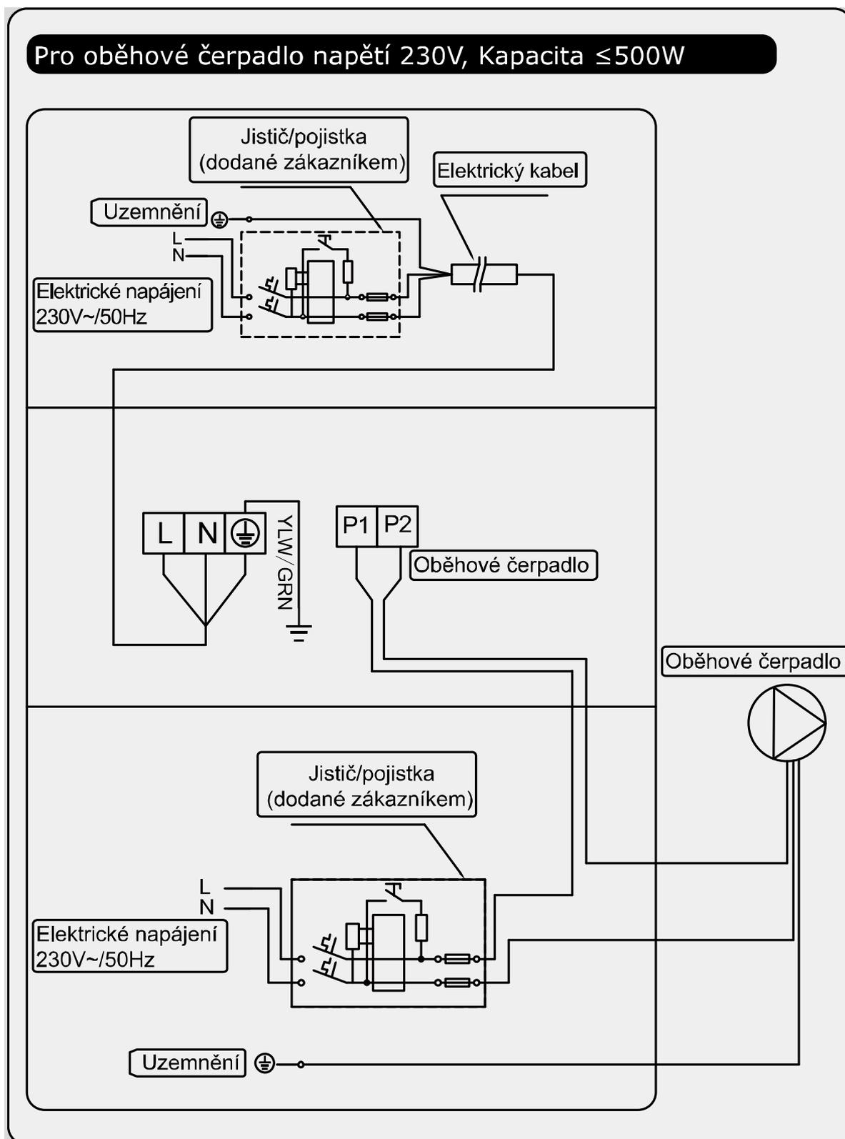
**Příloha 2: Schéma elektrického zapojení priority ohřevu (volitelně)**
