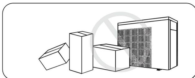
1.4.4. Legen Sie keine Gegenstände in den Ein- oder Auslass, da andernfalls die Effizienz der Wärmepumpe reduziert oder diese sogar gestoppt werden kann.
